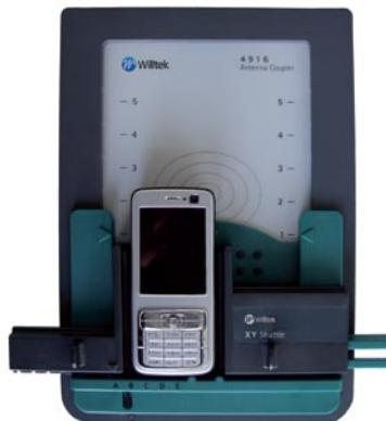
Auf dem XY Shuttle kann das Mobiltelefon in 25 Positionen von oben rechts bis unten links fixiert werden
